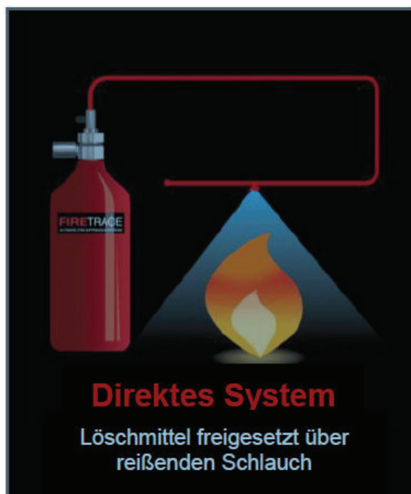
Abbildung 1: Darstellung des direkten und indirekten Löschmittelabgabesystems [U 10]
