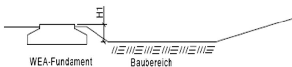
Abbildung 29: Beispiel für ein Fundament, wenn sich der Baubereich unterhalb der Fundamentoberseite befindet. Maximaler Höhenunterschied H1 = 1 Meter
