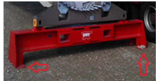
Abbildung 20: Beispiel einer Komponentenabstützung. Die Pfeile zeigen den Druckbereich (Aufstandsfläche)
