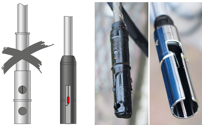
Grenzwertgeber alter und neuer Bauart
